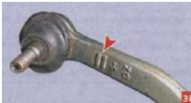
Рисунок 1.7 - Мітки на лівому наконечнику рульової тяги
