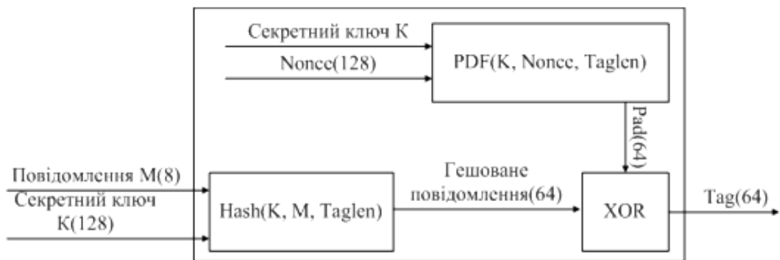
Рисунок 2.1 – Загальна схема універсальних геш-функцій UMAC -16/32
