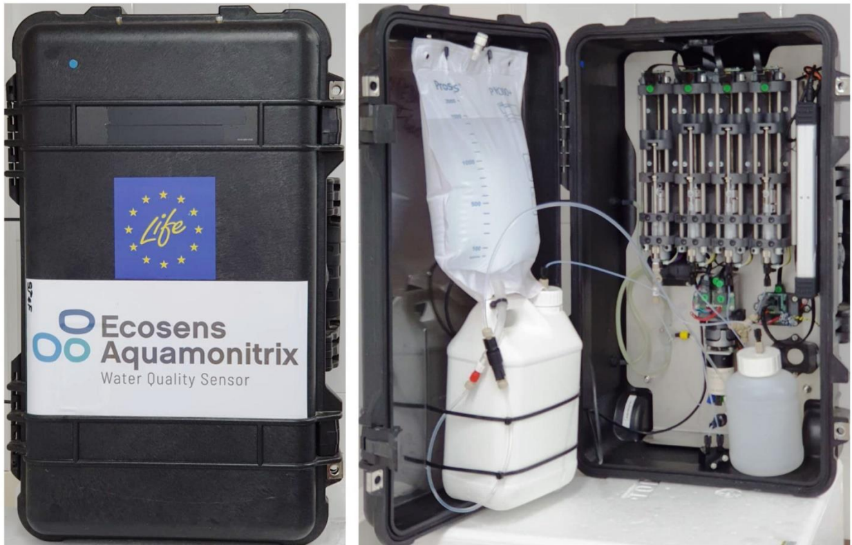
Рисунок 2.4 – Зовнішній і внутрішній вигляд інтегрованого датчика IoT для додатків моніторингу якості води.
