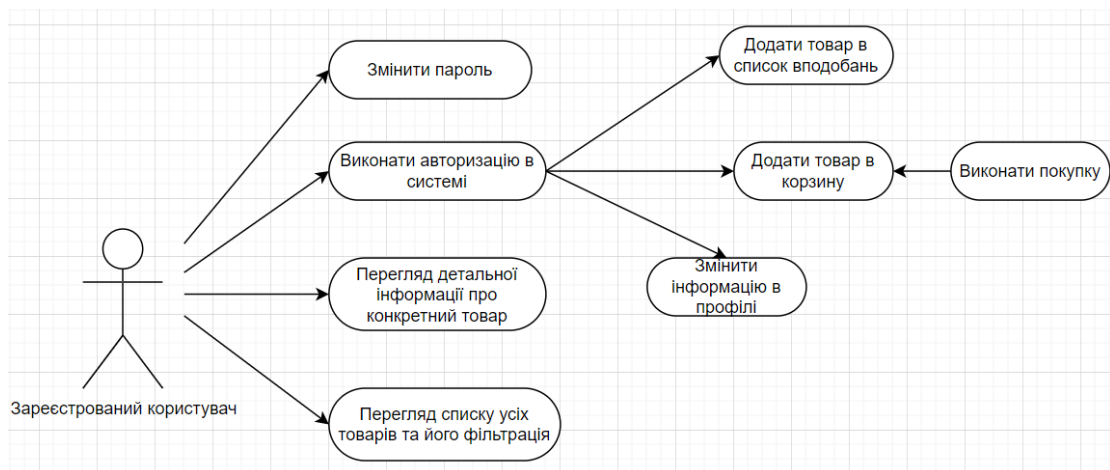
Рисунок 1.3 – Діаграма варіантів використання для актора «Зареєстрований користувач»
