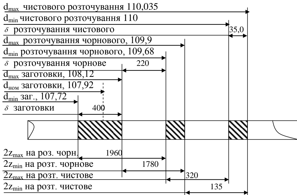
Рис. 2.1. Схема графічного розташування припусків і допусків на обробку отвору \varnothing 110^{+0,35} корпусу.
