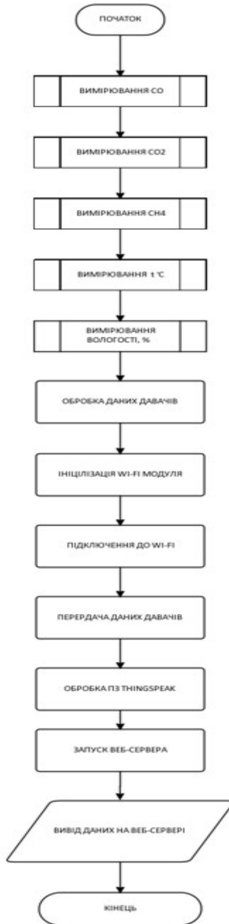
Рисунок 3.2 – Блок-схема алгоритму для виведення даних на ThingSpeak
