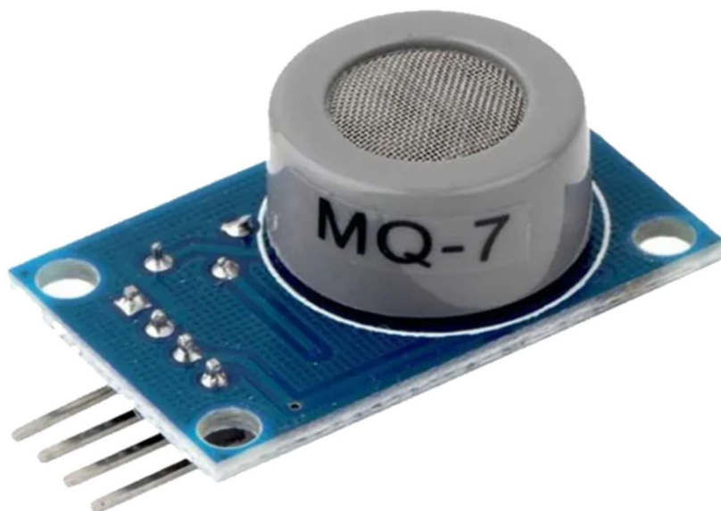
Рисунок 2.6 – Давач чадного газу MQ-7
