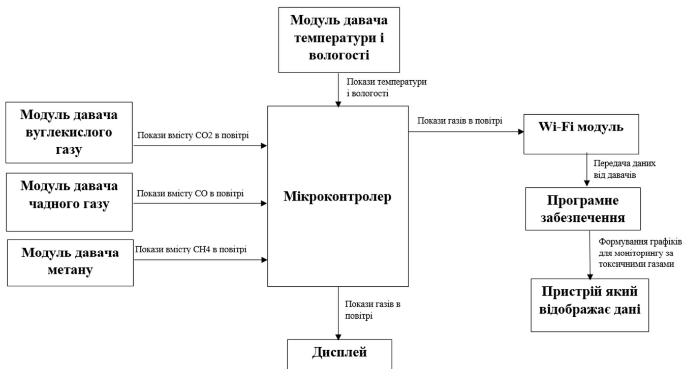
Рисунок 2.1 – Функціональна схема комп'ютеризованої системи ВМКШГП
