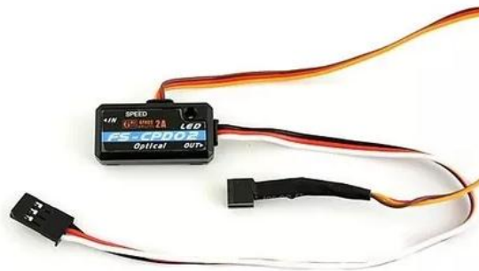
Рисунок 1.10 – Зовнішній вигляд оптичного датчика обертів
