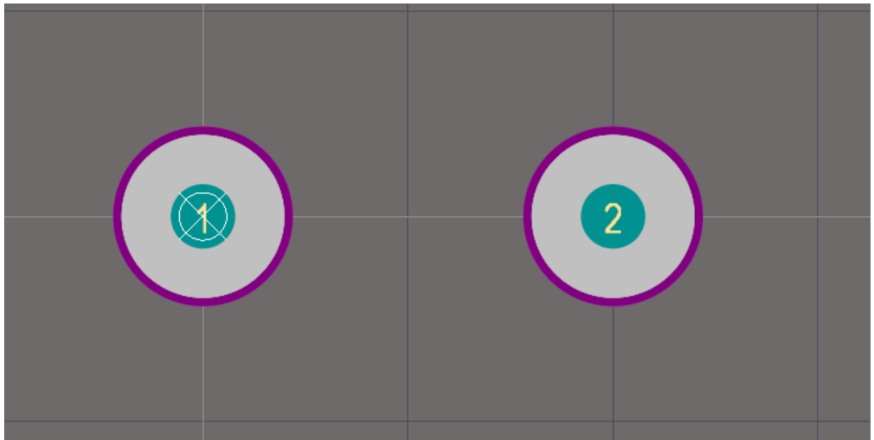
Рисунок 2.9 – Розміщення контактних площадок посадочного місця
