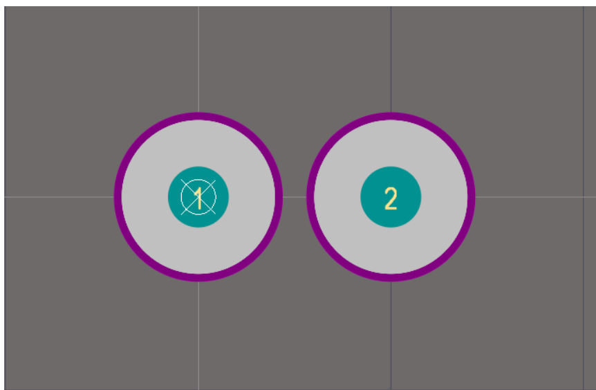
Рисунок 2.12 – Розміщення контактних площадок посадочного місця
