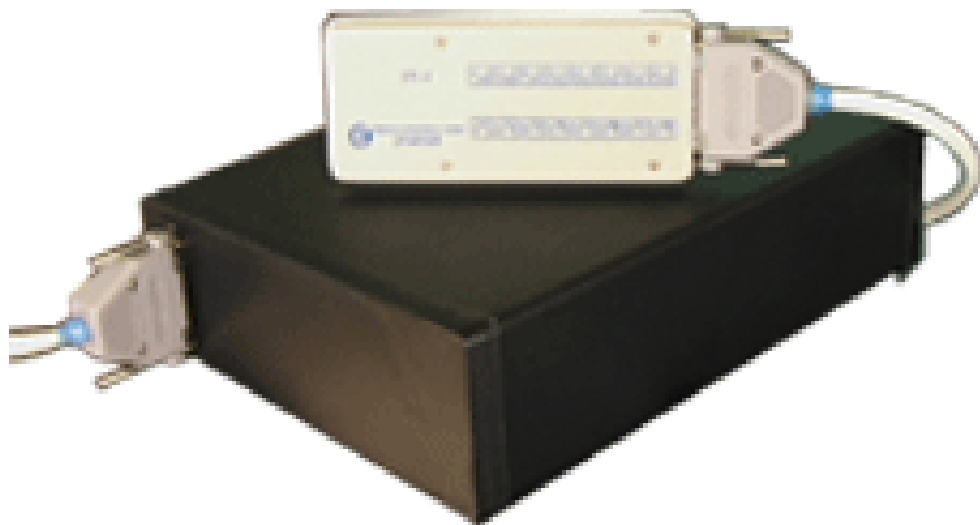
Рисунок 1.4 – Загальний вигляд багатоканального вимірювача температури ИТ-2
