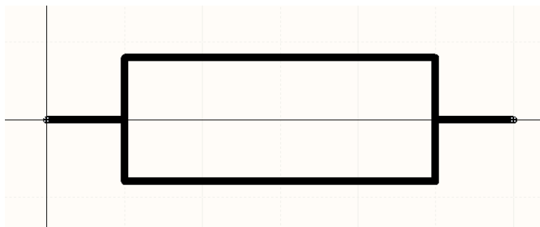
Рисунок 2.1 – Умовне графічне позначення резистора.
