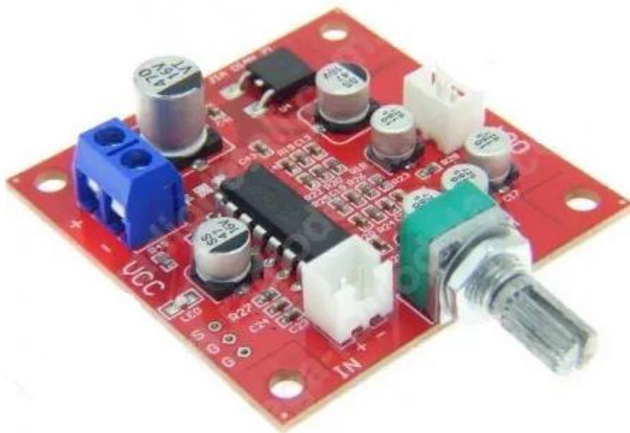
Рисунок 1.1– Блок ревербератора електронного на мікросхемі PT2399.
