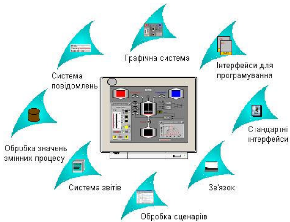
Рисунок 3.11 – Структура система візуалізації WinCC
