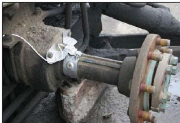
Рисунок 2.6 – Місце встановлення механічного датчика швидкості Датчик витрат рідини (ДРР-15)
