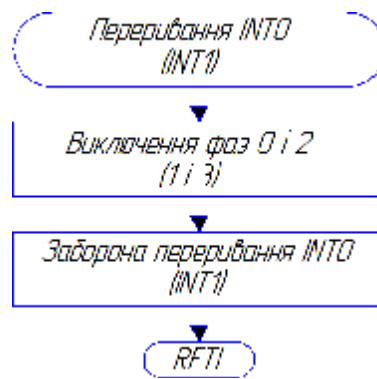
Рисунок 3.8 – Блок-схема переривань INT0 і INT1
