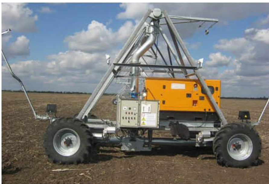
Рисунок 1.6 – Пристрій для внесення гербіцидів з водою при дощуванні машиною «Фрегат»
