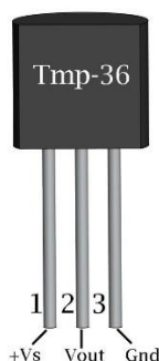
Рисунок 2.2 – Зовнішній вигляд і позначення виводів датчика
