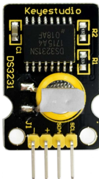
Рисунок 2.11 – Зовнішній вигляд модуля годинника DS3231
