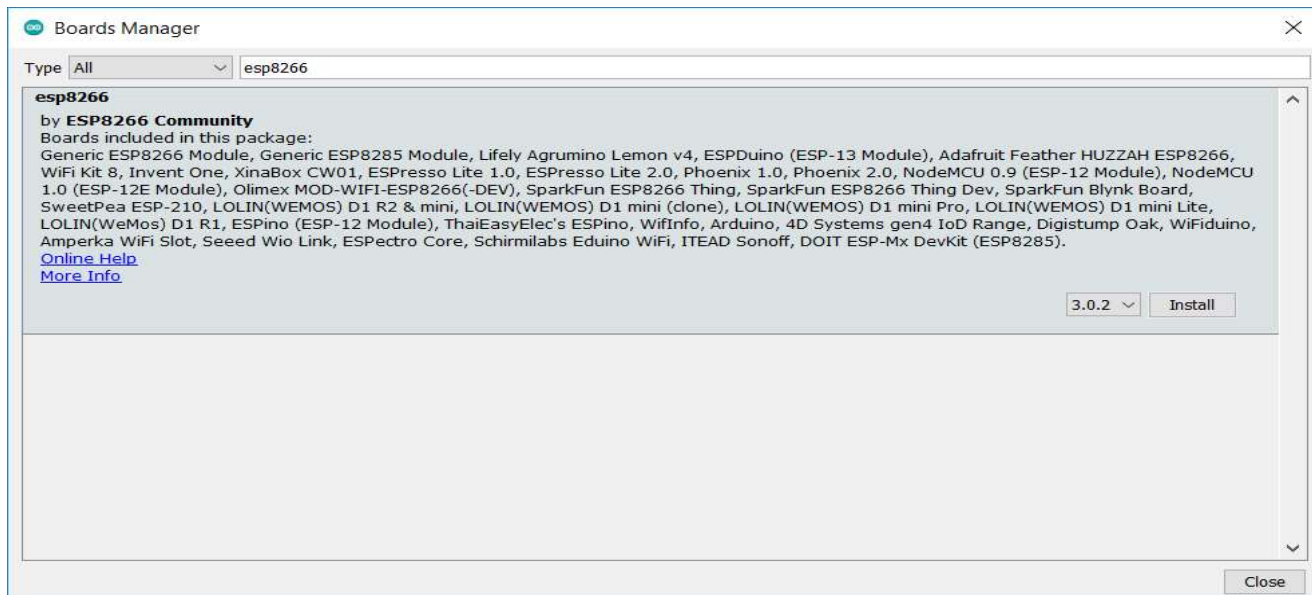
Рисунок 3.8 – Процес встановлення модуля в Arduino IDE для роботи з платформами, які працюють на базі мікроконтролера ESP8266
