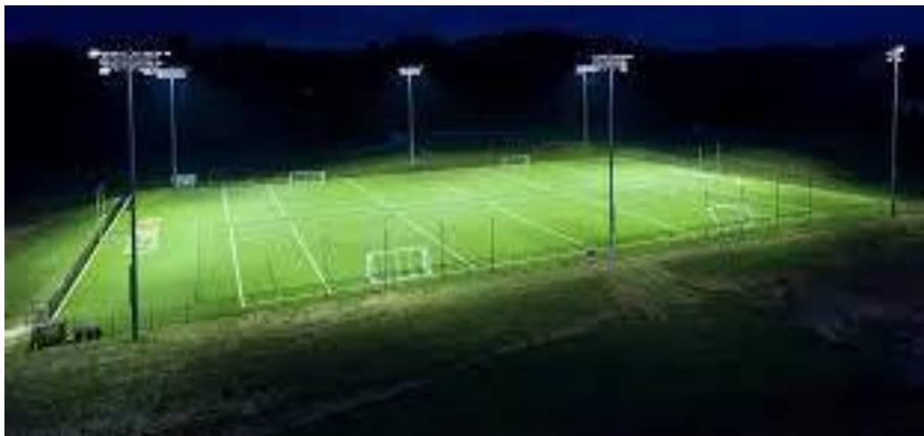
Рисунок 1.5 – Застосування шестищоголової системи для освітлення тренувального поля
