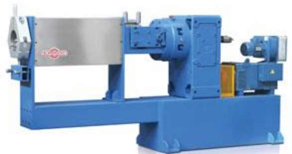
Рисунок 2.1 - Зовнішній вигляд та операційний блок екструдера для термопластів типу Е–150
