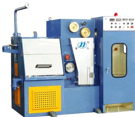
Рисунок 2.4 - Зовнішній вигляд машини середнього волочіння з відпалом типу DT-14
