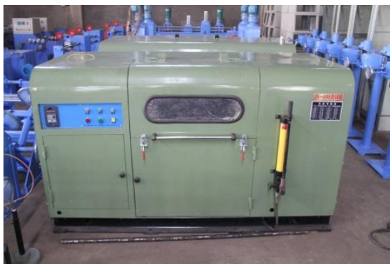
Рисунок 2.5 - Зовнішній вигляд машини для скручування провідників типу DSU-40
