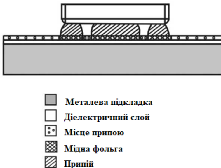
Рисунок 2.5 - Рекомендований спосіб монтажу виробу на друкованій платі (тепловідведення)
