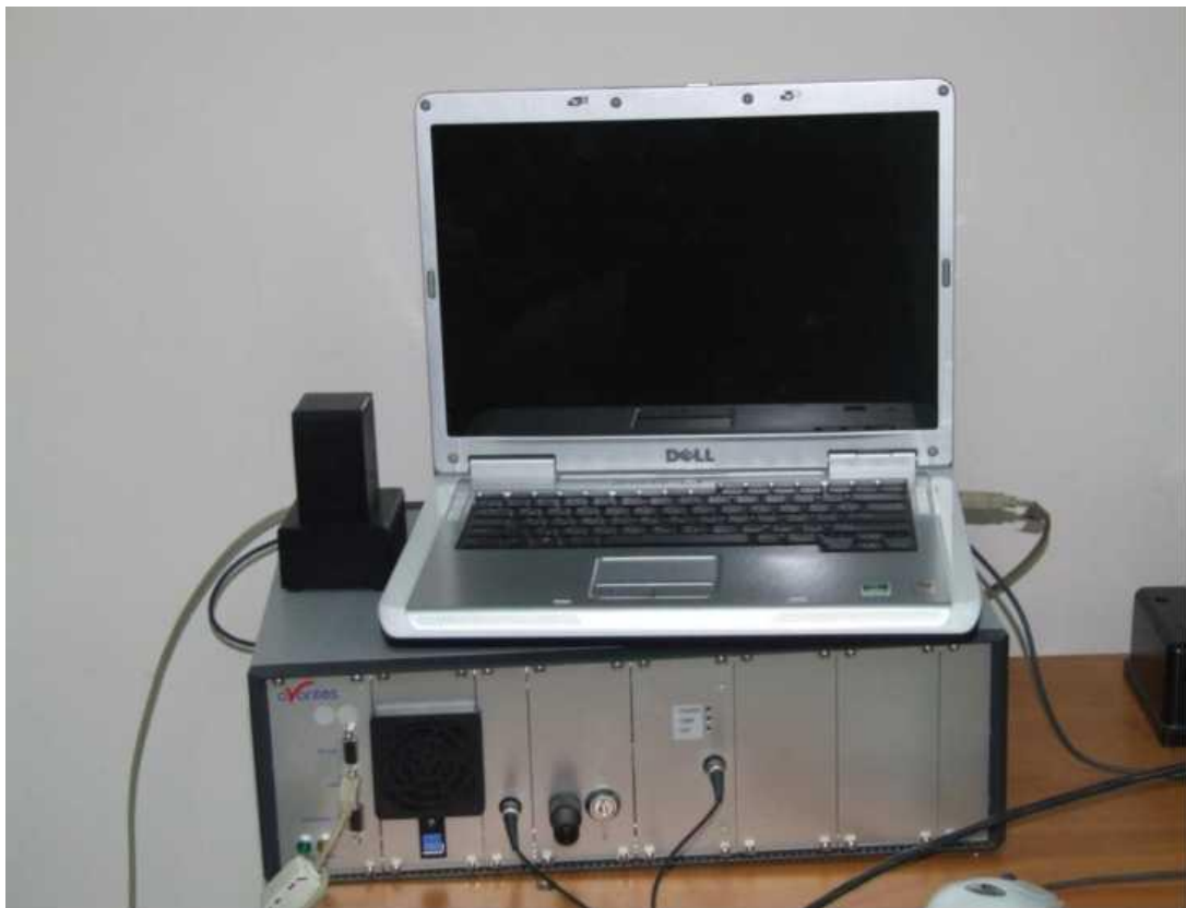
Рисунок 2.11 - Загальний вид системи для дослідження спектральних та колірних характеристик світлодіодів на основі блоку Avantes
