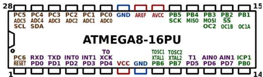
Рисунок 2.5 - Розміщення виводів мікроконтролера Atmega 8
