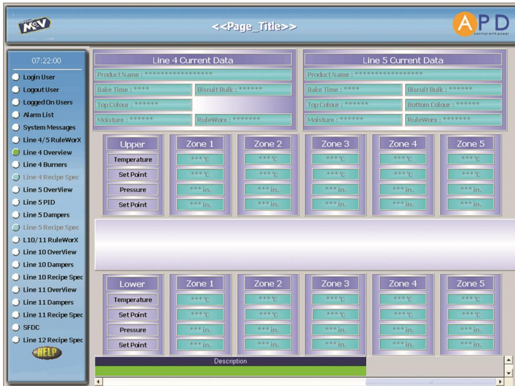
Рисунок 3.2 – мнемосхема головного вікна САКАДА системи
