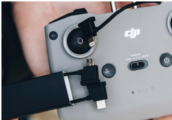
Рис. 2.6 – Пульт керування : а) наявні перехідники (Type - C, Lightning та MicroUSB); б) з підключеним до нього телефоном та запущеним додатком DJI Fly (б)
