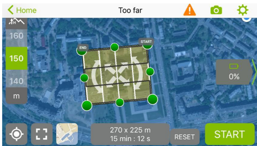
Рис. 2.1 – Приклад польотного завдання у програмному комплексі Pix4D
