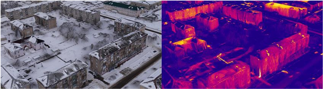
Рис. 2.2 – Тепловізійна зйомка за допомогою БПЛА
