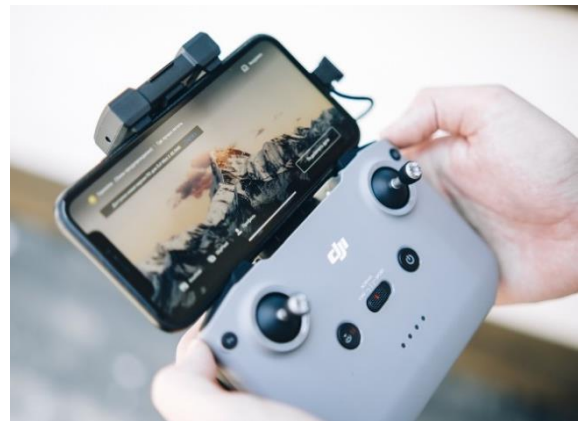
Рис. 2.6 – Пульт керування : а) наявні перехідники (Type - C, Lightning та MicroUSB); б) з підключеним до нього телефоном та запущеним додатком DJI Fly (б)
