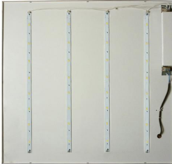
Рис 2.10 – Фотографія макета світильника
