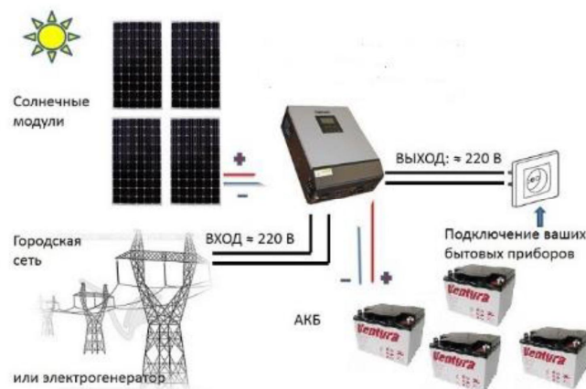
Рисунок 1.15 – Схема підключення гібридного інвертора в мережу
