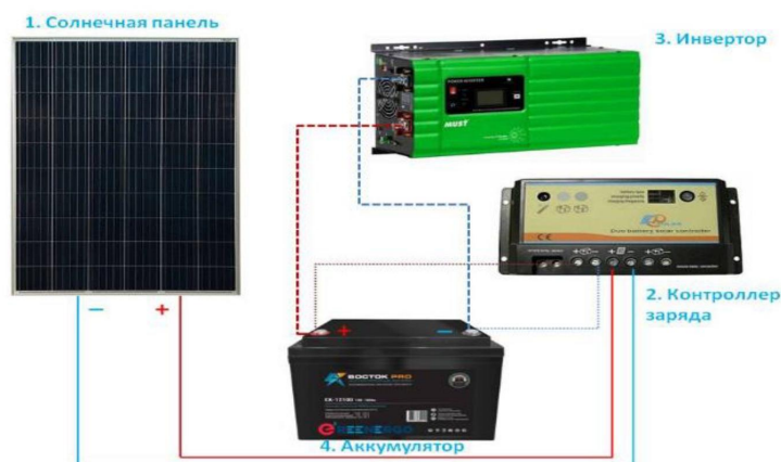
Рисунок 1.7 – Наочна схема з'єднання компонентів сонячної станції/
