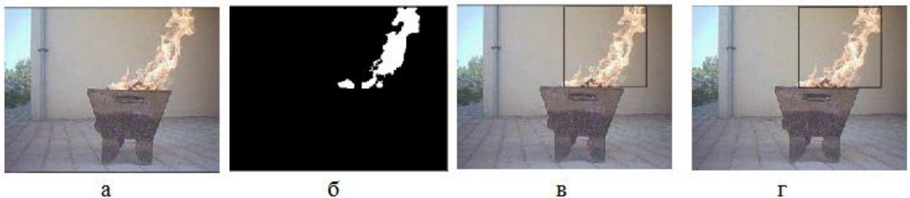
Рисунок 3.5 – Кроки алгоритму виявлення Пл. Відеопослідовність Bilkent\barbeq.avi : а – вихідний кадр; б – маска Пл; в – аналіз області-кандидата; г - результат роботи алгоритму
