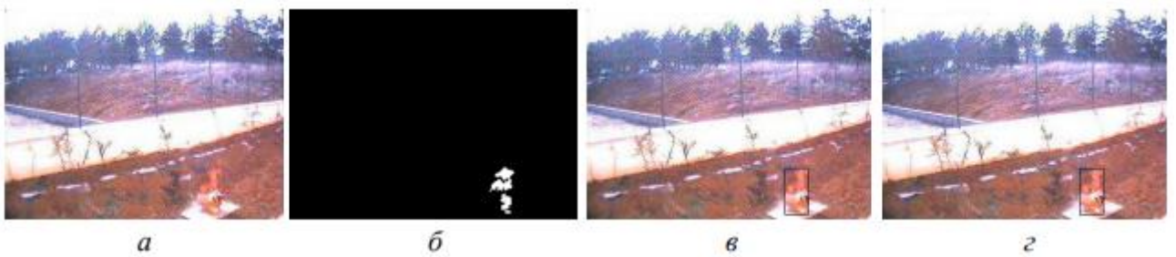
Рисунок 3.3 – Етапи роботи алгоритму виявлення Пл для послідовності http://signal.ee.bilkent.edu.tr/VisiFire/Demo/FireClips/Bilkent/fBackYardFile (кадр 65):
