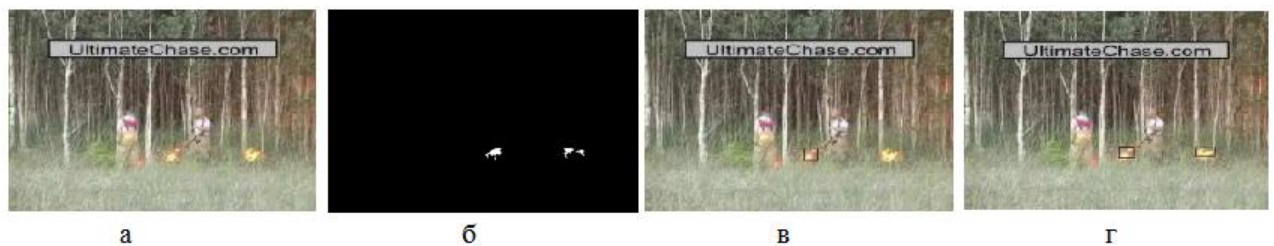
Рисунок 3.8 – Кроки алгоритму виявлення Пл. Відеопослідовність Bilkent\controlled1.avi: а – вихідний кадр; б – маска Пл; в – аналіз області-кандидата; г - результат роботи алгоритму
