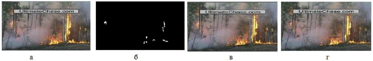
Рисунок 3.6 – Кроки алгоритму виявлення Пл. Відеопослідовність Bilkent\ForestFire1.avi: а – вихідний кадр; б – маска Пл; в – аналіз області-кандидата; г - результат роботи алгоритму
