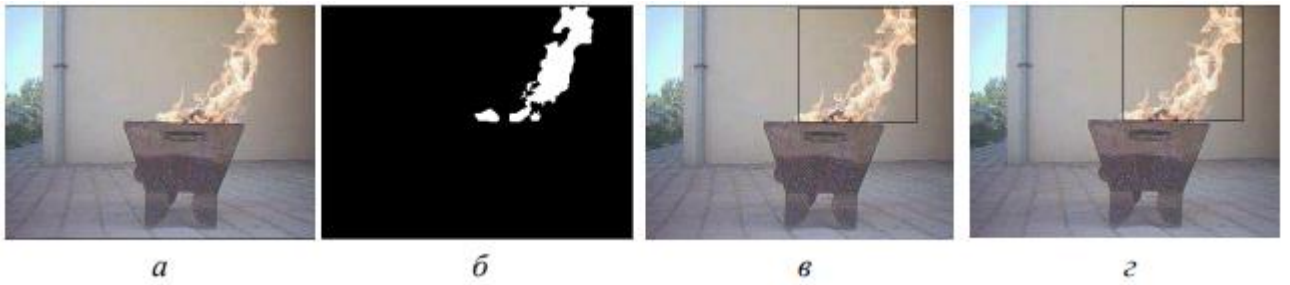
Рисунок 3.2 – Етапи роботи алгоритму виявлення Пл для послідовності http://signal.ee.bilkent.edu.tr/VisiFire/Demo/FireClips/Bilkent/barbeq (кадр 267):
