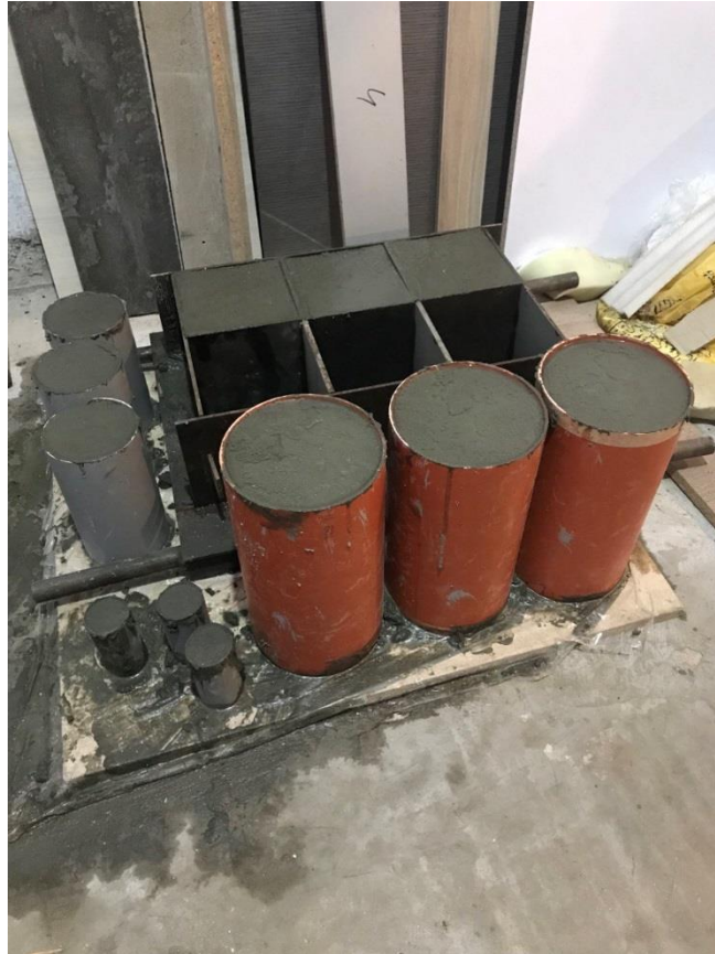
Рисунок 2.6 – Бетонний розчин залитий в опалубки
