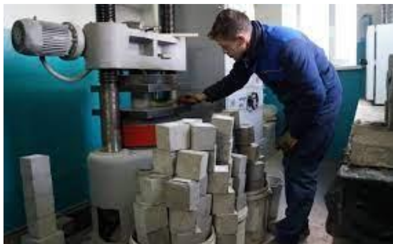
Рисунок 1.14 – Процес випробування бетонних зразків руйнівним методом
