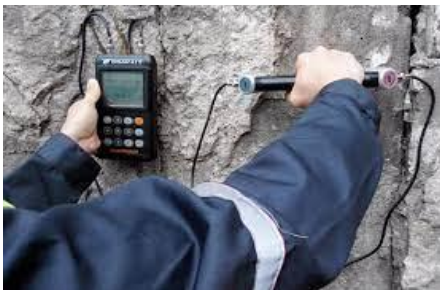
Рисунок 1.15 – Ультразвукове обстеження спеціальним приладом
