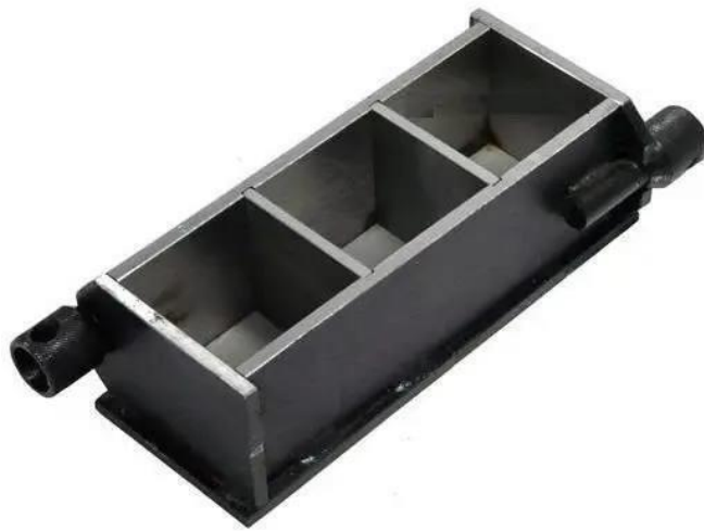
Рисунок 2.1 – Металічна опалубка для заливки кубічних зразків
