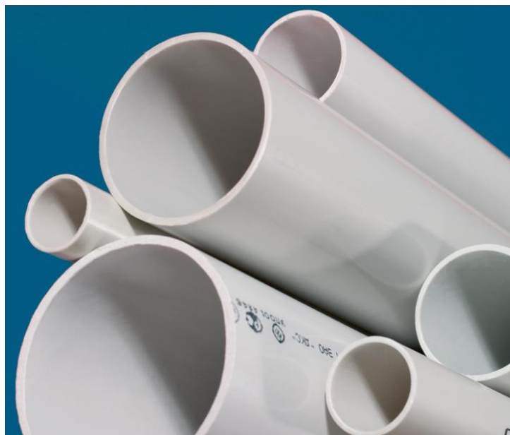
Рисунок 2.2 – Пластикові труби, як опалубка для циліндричних зразків
