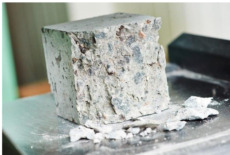
Рисунок 1.13 – Зруйнований контрольний зразок
