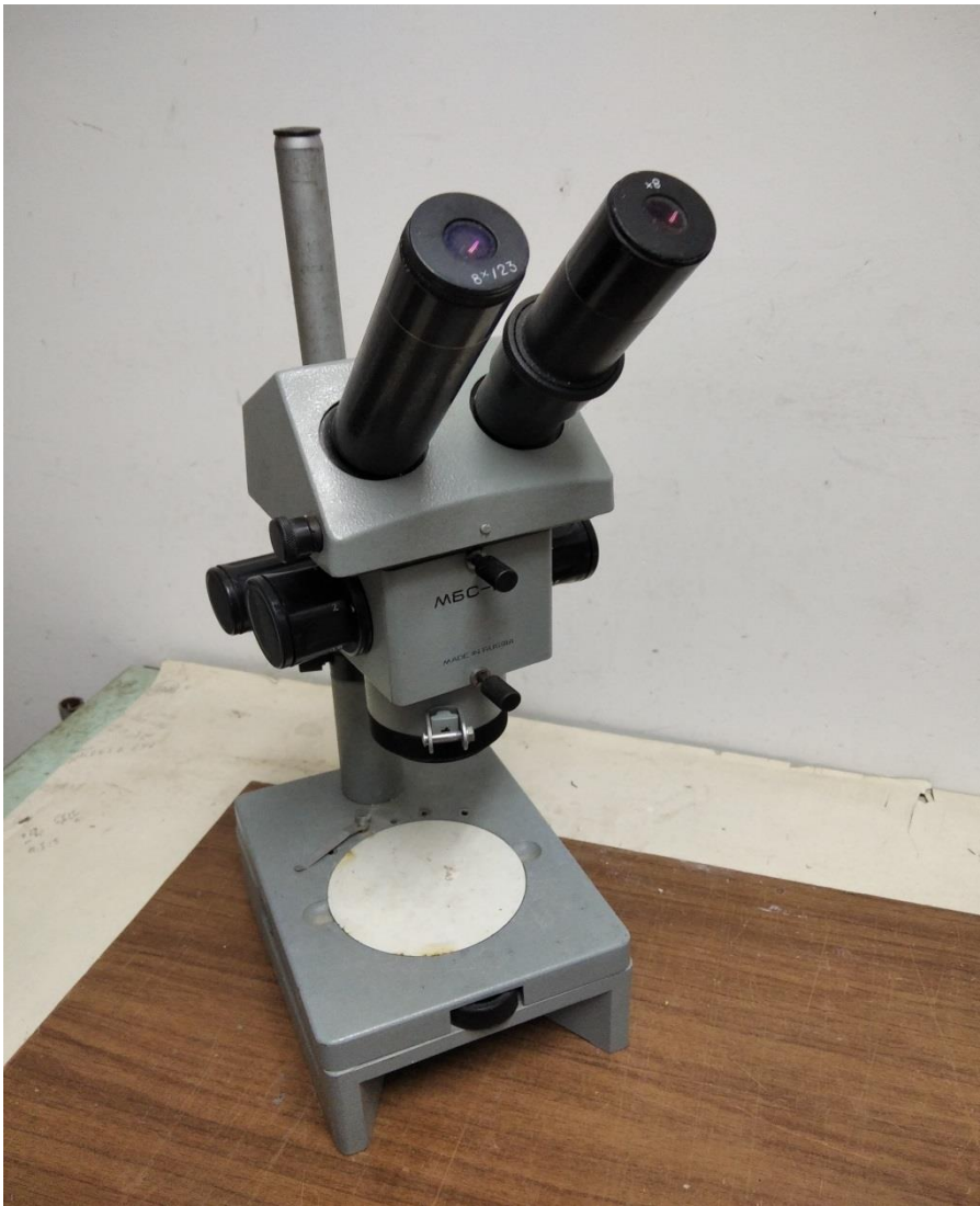
Рис 3. 11. Лабораторний мікроскоп для визначення пористості бетонних кубиків.
