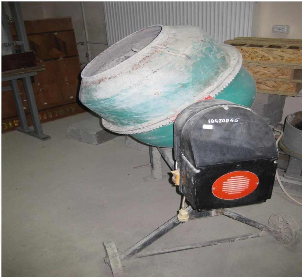
Рис.3.1 Бетономішалка марки Кентавр БМ-160Е.
