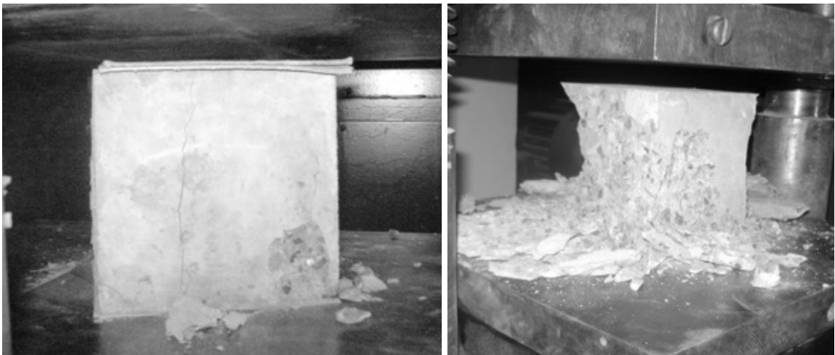
Рисунок 24. Випробування кубиків на міцність та характер їх руйнування.
