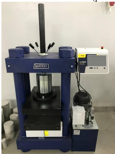
Рис. 1 Випробувальна машина для стискання бетону
