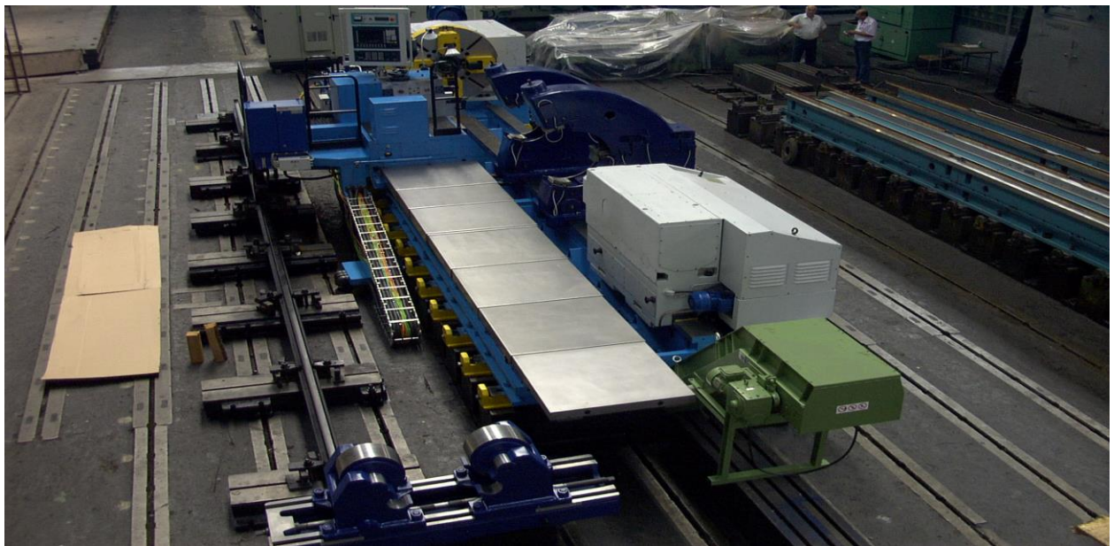
Рисунок 2.2. Токарний верстат із ЧПК моделі КЖ16275Ф3 на збиральній ділянці
