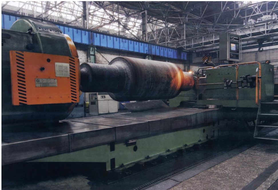
Рисунок 1.2. Токарний верстат моделі КЖ 16274.Ф3
