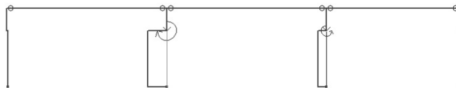
Рис.2.17 Епюри поздовжніх зусиль для завантаження 5
