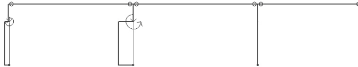
Рис.2.14 Епюри поздовжніх зусиль для завантаження 4
