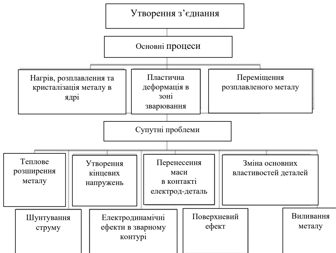
Рисунок 2.2 – Утворення з'єднання методом шовного зварювання
