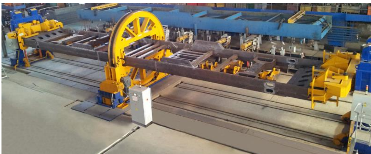
Рис. 4.3. Загальний вигляд зварювального кантувача [16]
