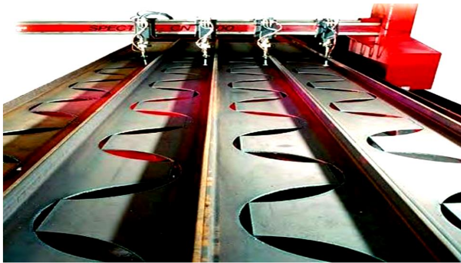
Рис. 3.5 Розрізання чотирьох прокатних двотаврів на машині термічного різання з ЧПУ типу CNCMS
