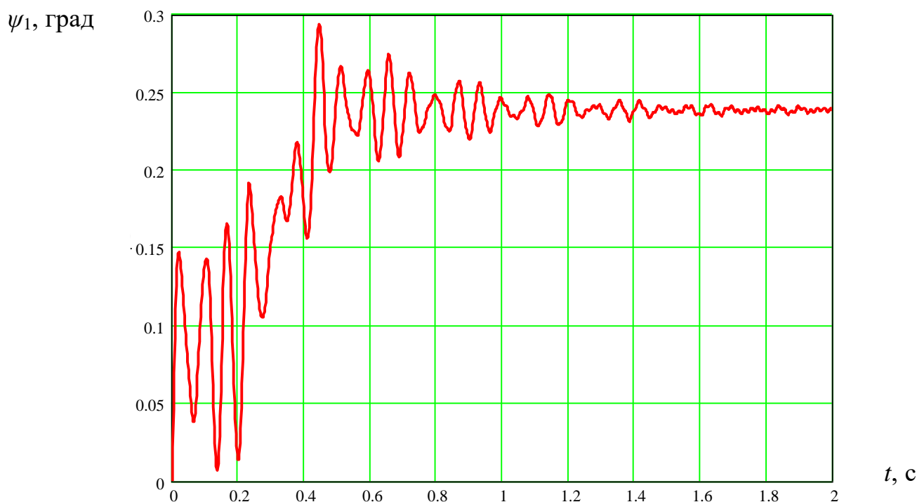
Рисунок 2.8 - Графік зміни кута відносної деформації різального інструменту в часі для випадку нормальної роботи патрона без спрацювання запобіжного механізму
