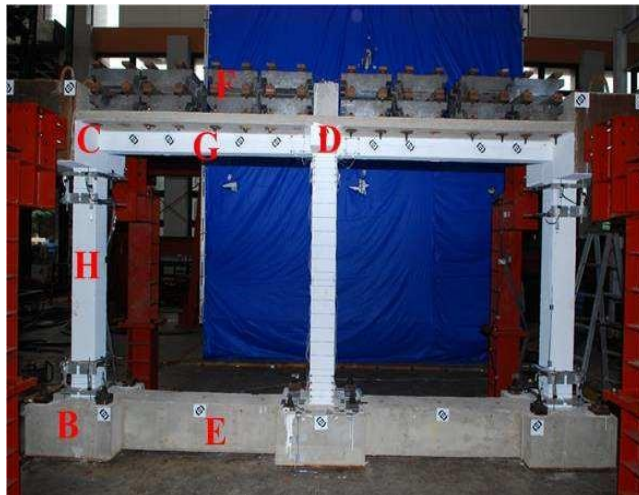
Рисунок 1. Зразок каркасної конструкції з залізобетону
