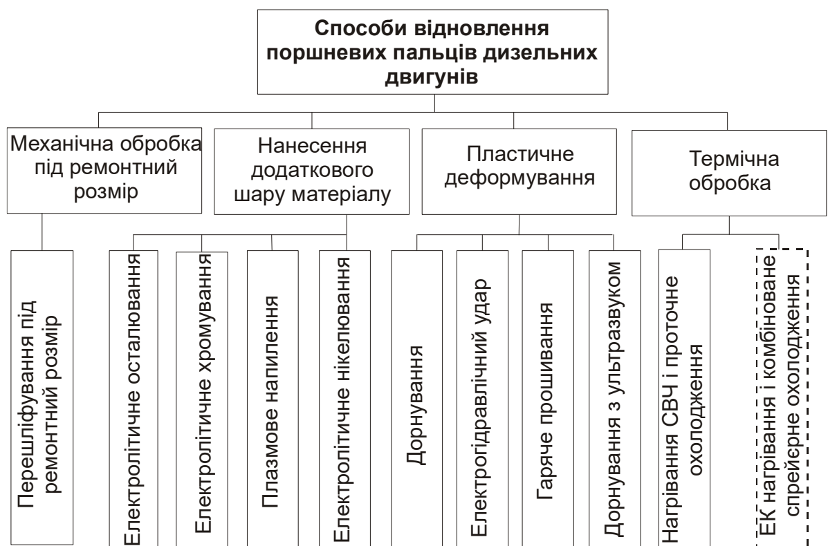
Рис. 2.1. – Блок-схема способів відновлення поршневих пальців дизельних двигунів
