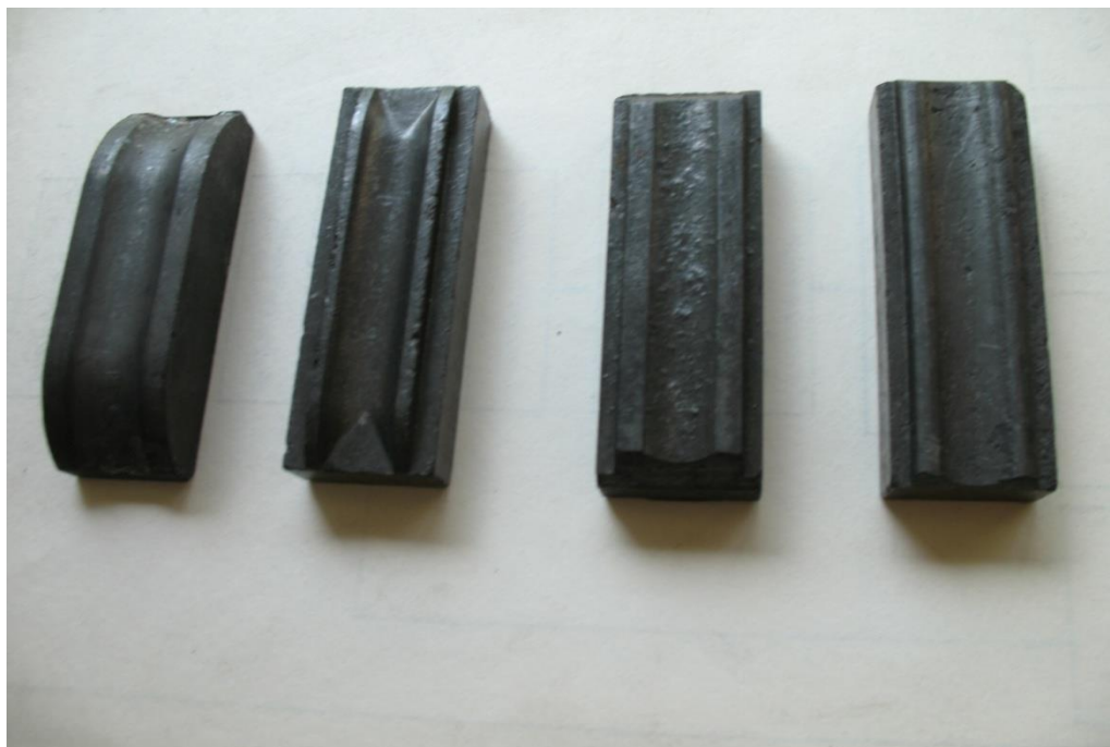
Рисунок 1.2. Різновиди тролейбусних вставок.
