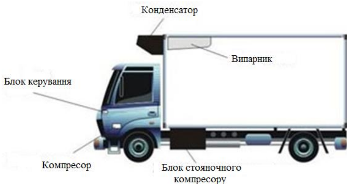
Рисунок 2.1 – Особливості конструкції авторефрижераторів
