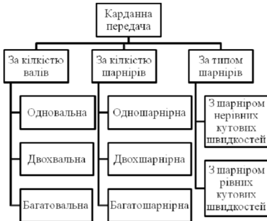
Рисунок 1.3 – Поділ карданних передач за видами
