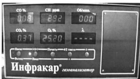
Рисунок 2.9 – Перевірка на токсичність відпрацьованих газів
