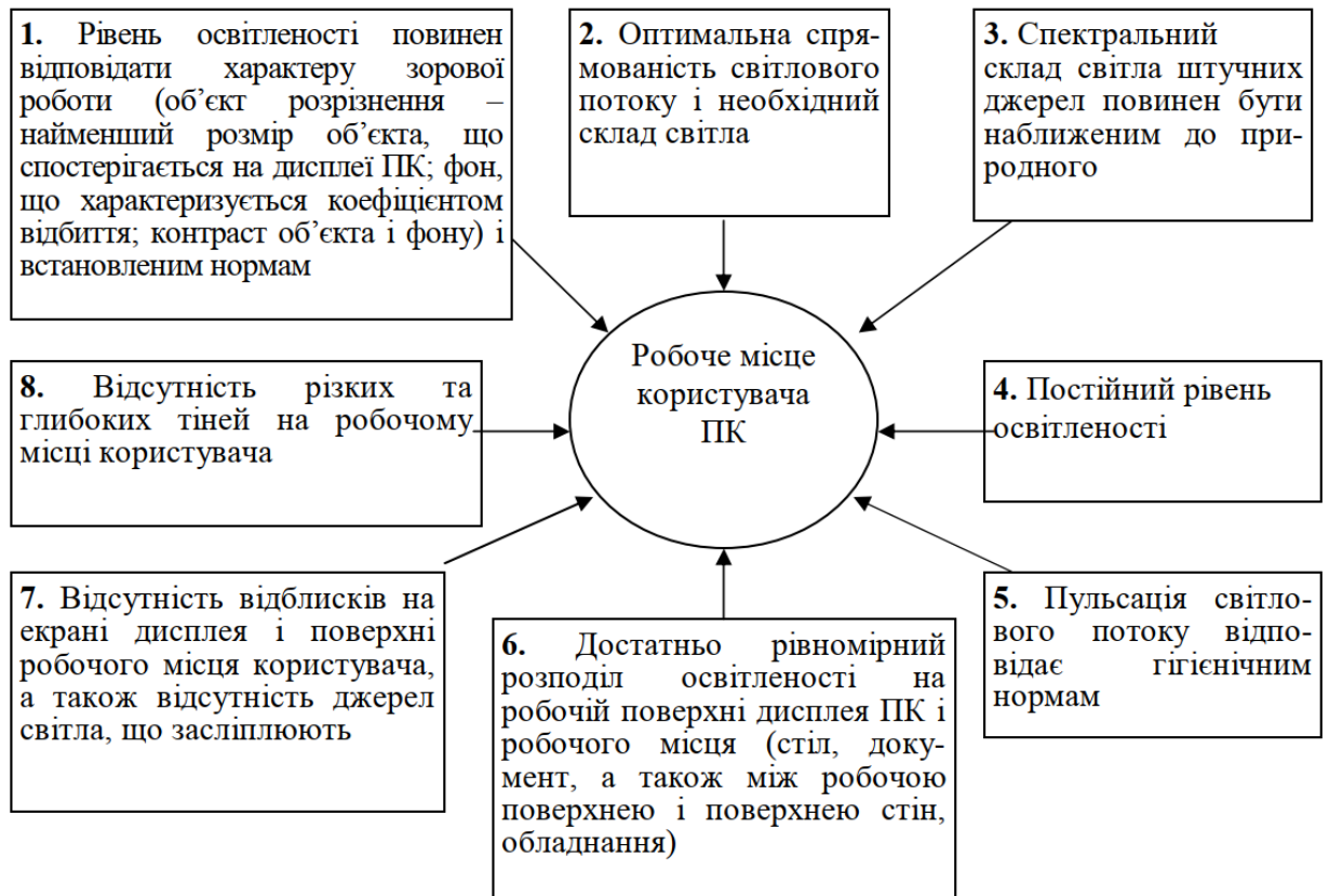
Рисунок 4.1 – Вимоги до системи освітлення робочого місця користувача ПК
