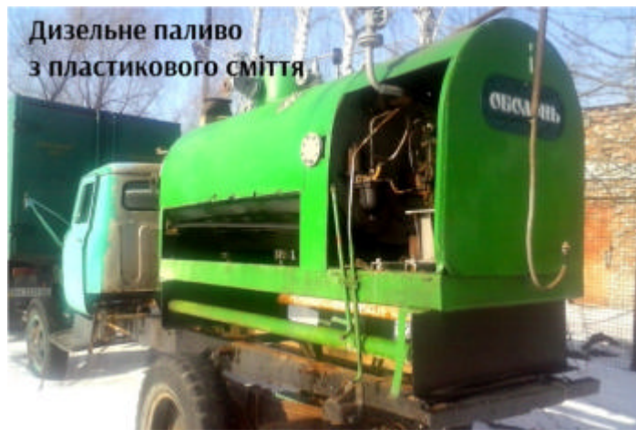
Рисунок 1 – Мобільна установка переробки пластикових відходів у дизельне паливо компанії «Оболонь Оіл»
