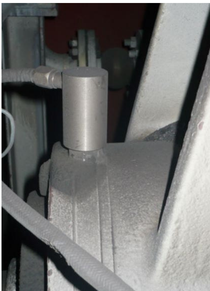
Рисунок 3.4 – Розміщення давача VS-069 на об'єкті вимірювання вібрації
