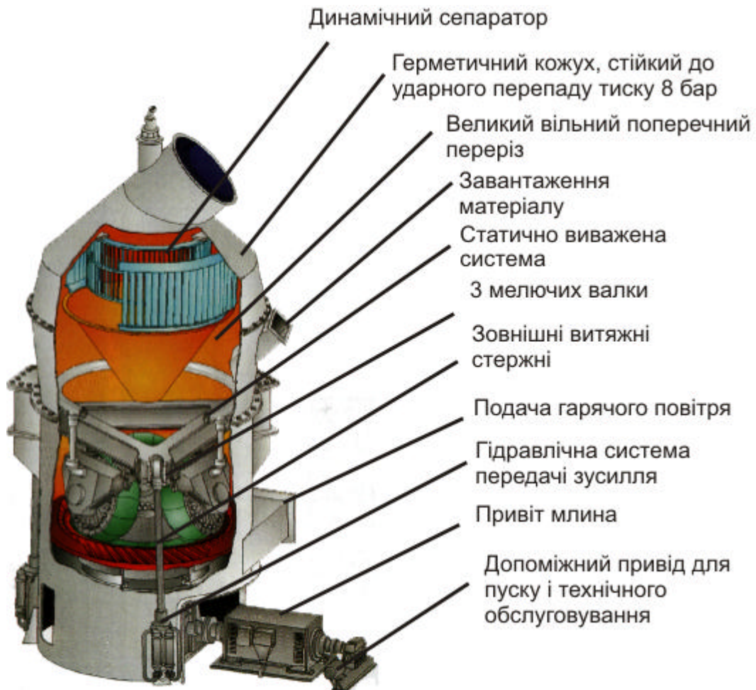
Рисунок 1.7 — Вертикальний валковий млин PFEIFER – MPS 180BK
