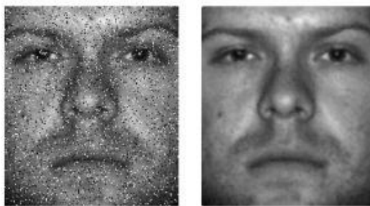
Рис. 2.5. Результат застосування медіанної фільтрації до зашумленого зображення
