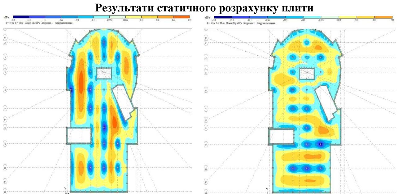
Рисунок 3.5 – Ізополя внутрішніх зусиль M_x , M_y в елементах плити перекриття від дії постійного навантаження
