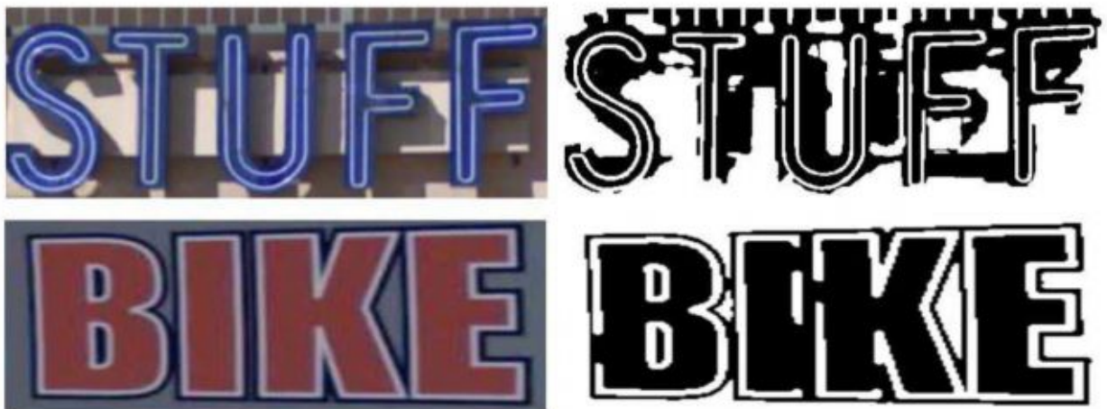
Рис. 1.2. Приклад некоректної роботи алгоритму бінаризації
