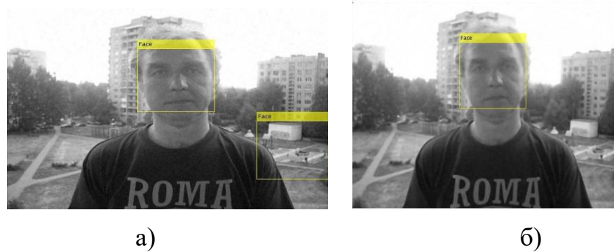
Рис. 2.13. Результат спільної роботи методу Віоли-Джонса та адаптивного медіанного фільтра з апертурами а) [3 3] б) [5 5]
