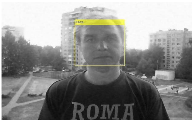
Рис. 2.15. Результат виділення обличчя із застосуванням білатерального фільтра та методу Віоли – Джонса
