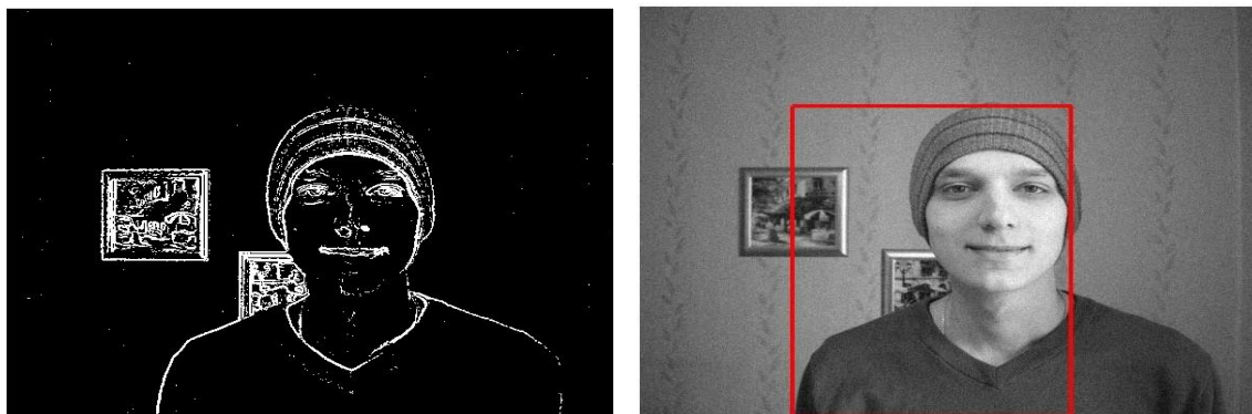
Рис. 1.11. а) Сегментоване зображення оператором Собеля б) Отримане зображення
