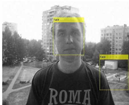
Рис. 2.11. Результат спільної роботи фільтра Вінера з апертурою 3 та методу Віоли – Джонса
