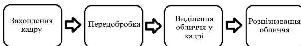
Рис. 1.1. Загальна схема алгоритму розпізнавання обличчя у кадрі
