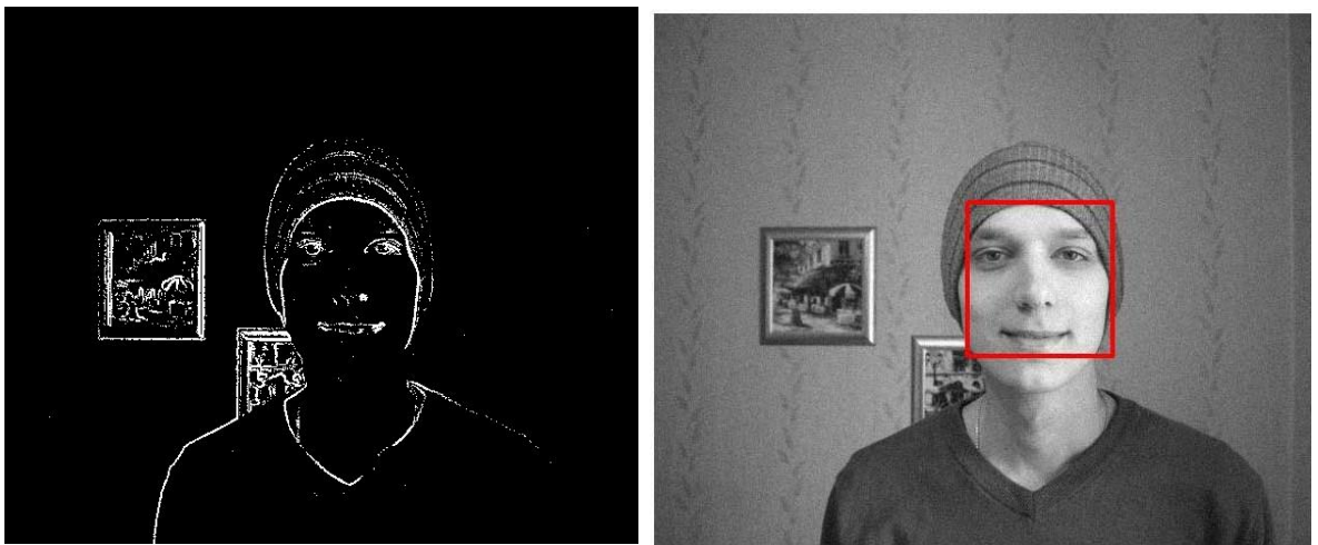
Рис. 1.13. а) Сегментоване зображення оператором Робінсона б)
