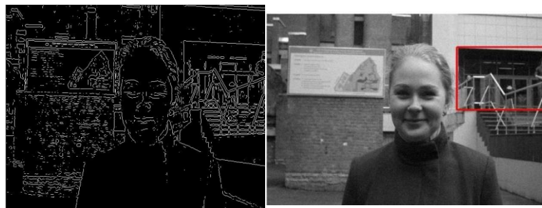
Рис. 1.16. а) Сегментоване зображення методом LOG б) Отримане зображення
