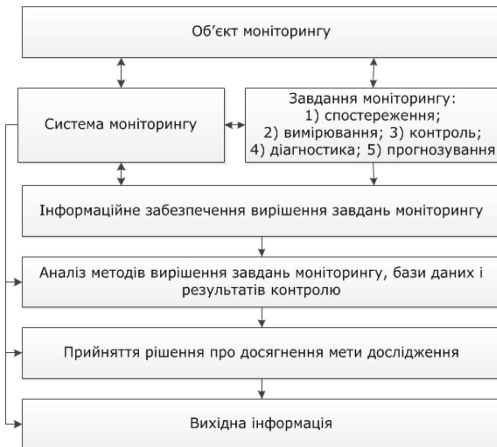
Рис. 1.2. Структурна схема процесу моніторингу атмосферного повітря
