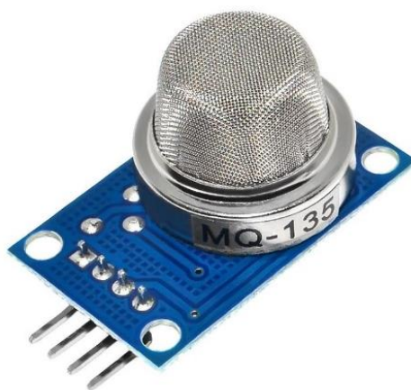
Рис. 2.12. Зовнішній вигляд модуля давача якості повітря MQ-135
