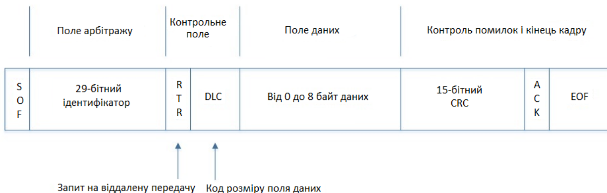
Рис. 1.3. Структура пакету повідомлення CAN
